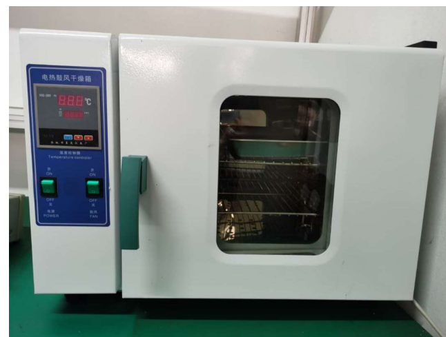
骨架变形、起泡高温烘烤试验
