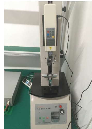
骨架强度和针脚拉力测试
