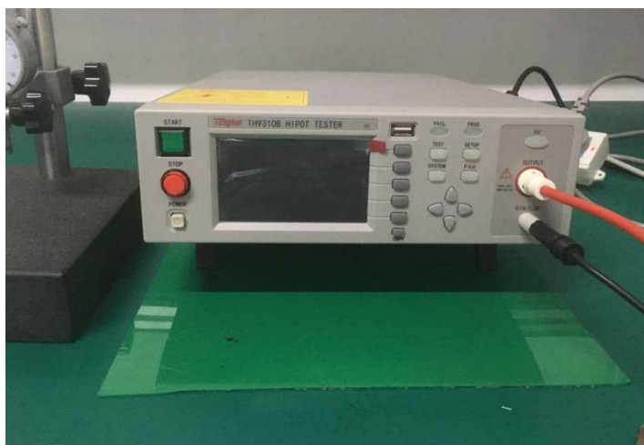
骨架绕线区对针脚及磁芯耐压测试，插针插裂验证
